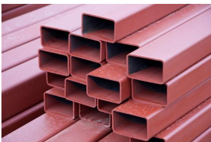
Ejemplo pintura en al acero A500. I. Imagen obtenida y disponible en: [ https://tinyurl.com/4rfYE8875tyr ].
