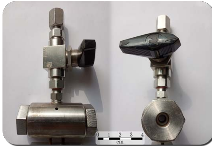
Figura 5.2: Fotografías de la celda de transmisión de alta presión
