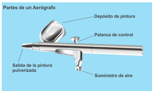
Figura 21. Anatomía externa del aerógrafo.
