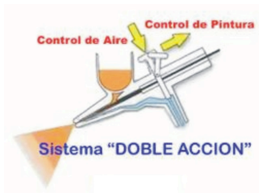
Figura 20. Función del aerógrafo de doble acción.
