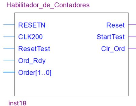
Figura 3.16: Diagrama de bloques del módulo Habilitador de Contadores.
