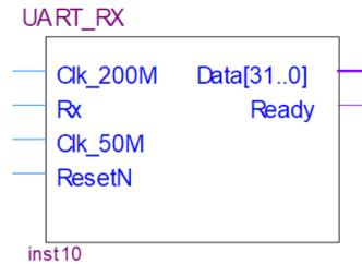
Figura 3.4: Módulo receptor UART.
