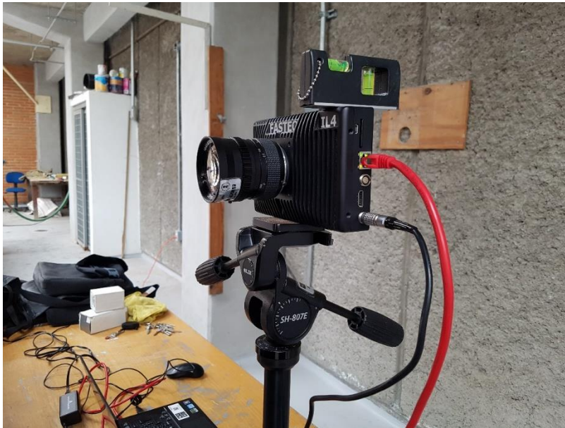
Fig. 5.10 Nivelación de la cámara de alta velocidad
