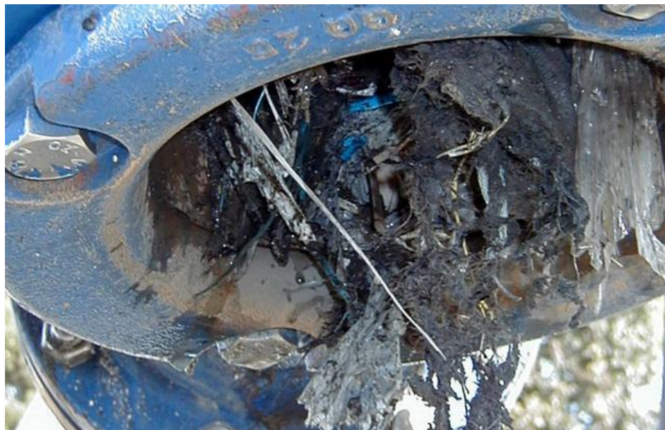
Fig. 1.5 Bomba con impulsor atascado
