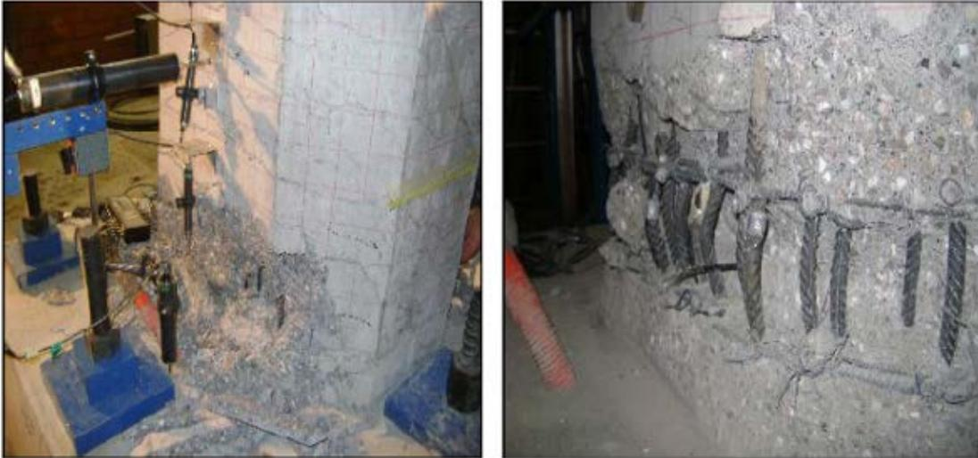
***Fig. 2-14 Daño en la base de la columna del espécimen C-4, aplastamiento del recubrimiento y pandeo del acero longitudinal***
