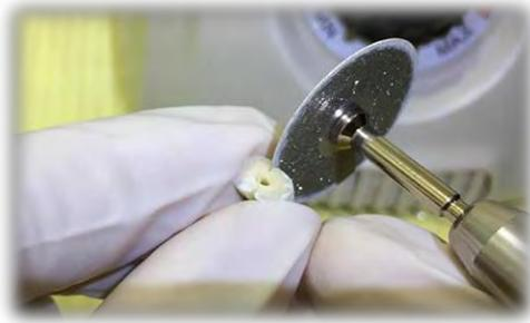
**Fotografía 16.** Se realizaron acanaladuras con un disco de diamante <sup>FD</sup>.
