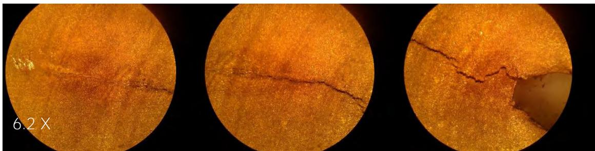
*Figura 32. Seguimiento de trayectoria de agrietamiento. Imágenes macro obtenidas de microscopio óptico 6.2x. Probeta II*
