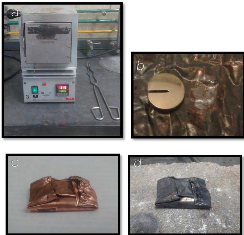
*Figura 15. A) Horno de Tratamientos Térmicos. B) Probeta expuesta después del TT. C) Probeta previo al TT. D) Probeta después al TT.*
