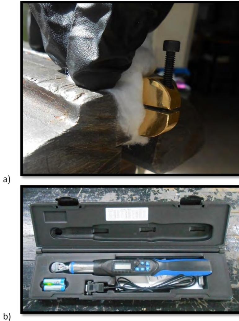
*Figura 12. a) Probeta maquinada y preparada metalográficamente con el tornillo para tensionar. b) Torquímetro Airon Tools*
