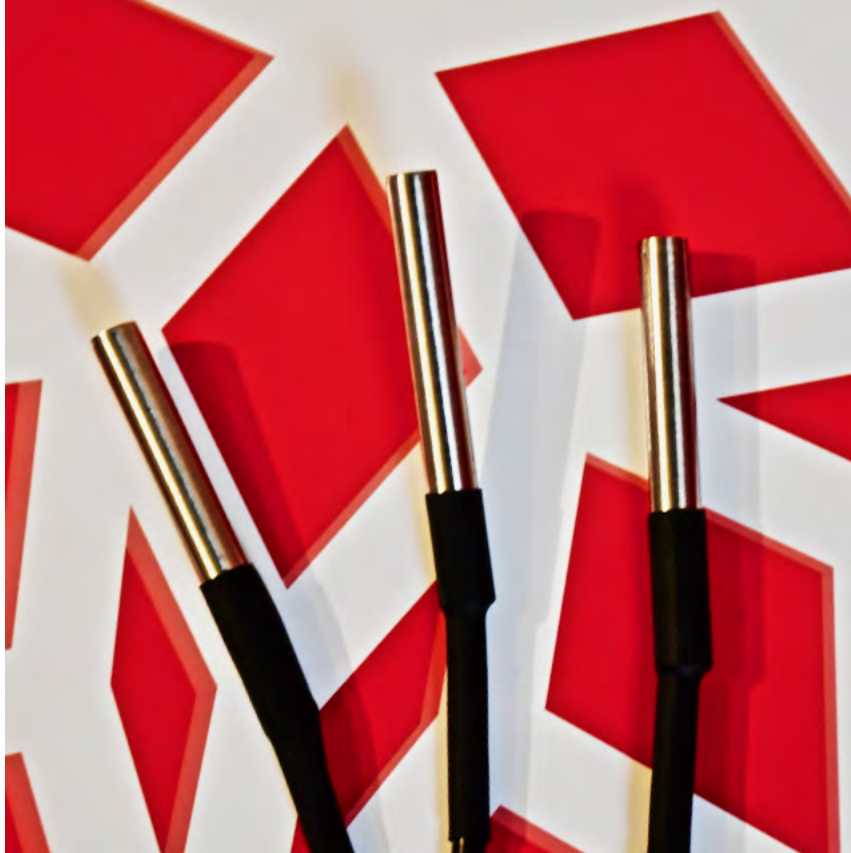
Figura 4.5: Visualización de 3 sensores de temperatura DS18B20 con un encapsulado en acero inoxidable.
