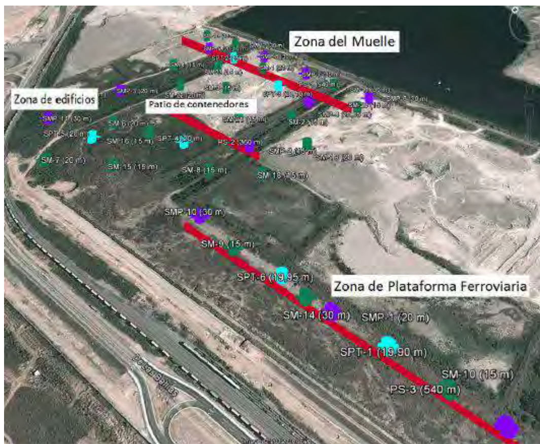
FIGURA 12. Esquema de localización de los puntos de investigación. “TYPISA, Ingenieros consultores y arquitectos (2012), Informe de caracterización geotécnica-TEC II, p.p. (16).”
