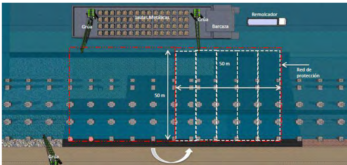
FIGURA 113. Desplazamiento de red de protección “ICA Dirección de Puertos, agua y minería (2014), Documento 1208-Procedimiento Constructivo del muelle, Rev. 02 (28-agosto-2014), p.p. (50).”
