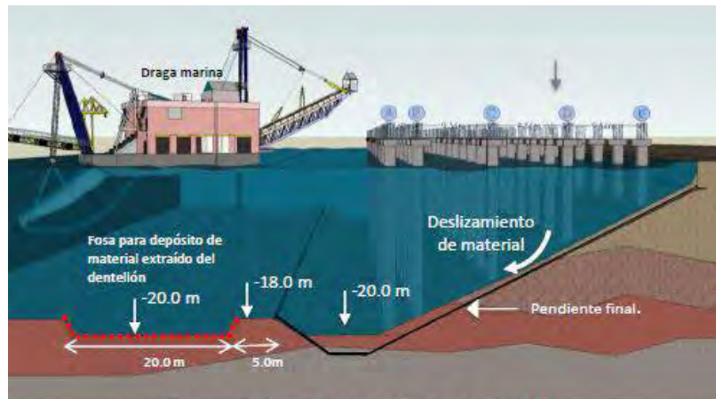
Vista posterior. Dragado de Fosa de depósito.
