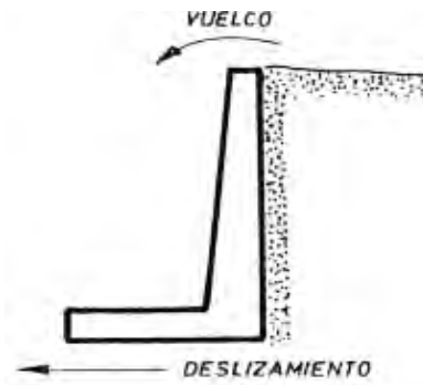
Figura: 2.11 Muro carente de talón.
