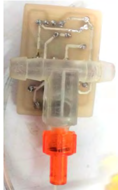
Figura 36. Adaptación del catéter con el circuito del sensor de Presión
