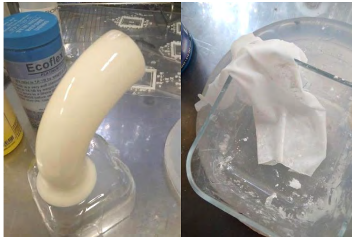
Figura 27. Fabricación de actuador suave: molde recubierto de silicón y extracción de la membrana [17]
