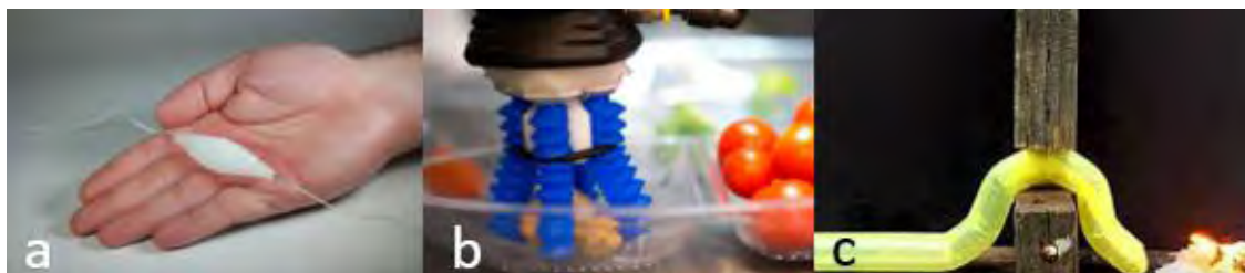
Figura 18. Actuadores suaves implementados como músculos artificiales (a), robots manipuladores (b) y robots de búsqueda (c) [23, 34, 35]
