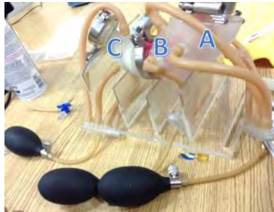
Figura 20. Configuración de pruebas para la generación de la onda peristáltica
