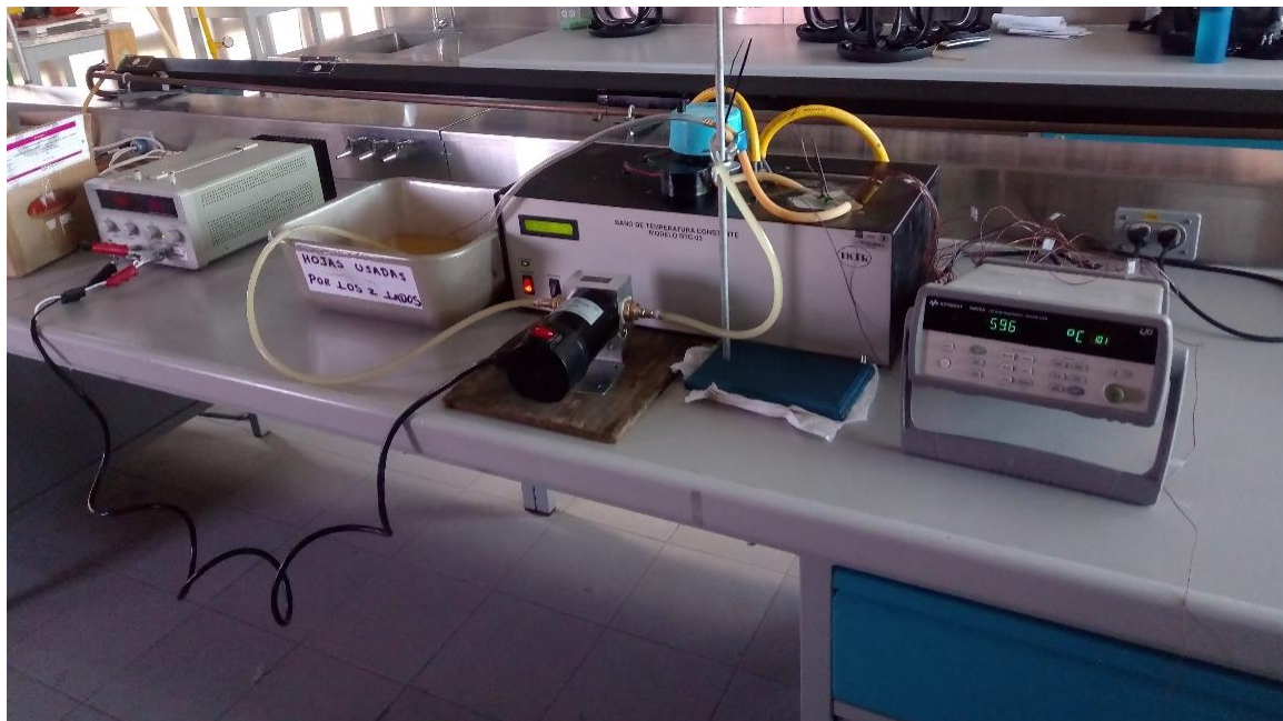
Ilustración 5.17 Foto donde se aprecia la tina con aceite a temperatura ambiente, la bomba, el baño térmico y el adquisidor de datos utilizados durante el tercer experimento.
