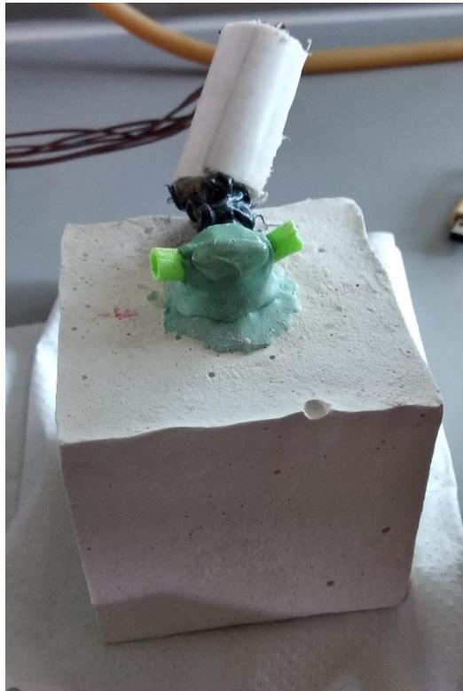
Ilustración 5.15 Foto donde se muestra el modelo de yeso con el cabezal en la parte superior del pozo.
