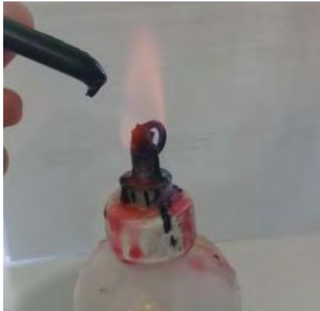
Figura 17 Plastificación con lampara de alcohol. <sup>17</sup>
