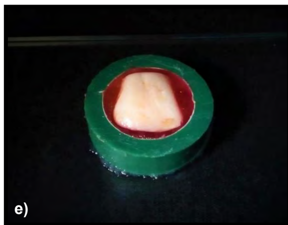
Fig. 6. Paso a paso de la inclusion de las muestras en resina acrílica. a) Materiales utilizados. b) Molde de plastico de una pulgada de diametro sobre la loseta con separador. c) Se coloca indicador y resina acrílica transparente. d) Se agrega polvo y liquido de resina acrílica en el molde. e) Se coloca el diente dentro del molde. f) Se retira la muestra del molde. F.D
