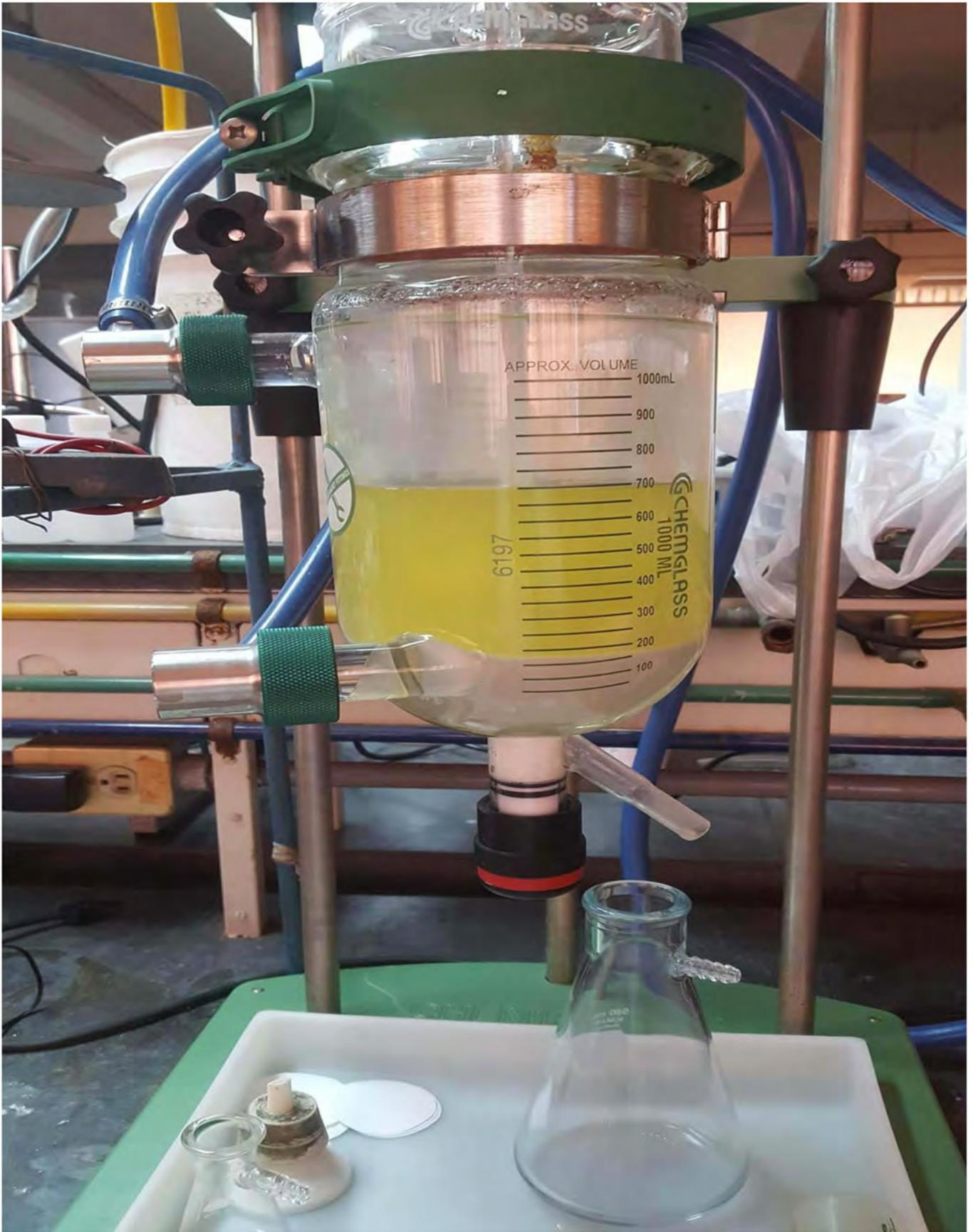
Figura 23. Imagen del reactor al haber terminado la lixiviación
