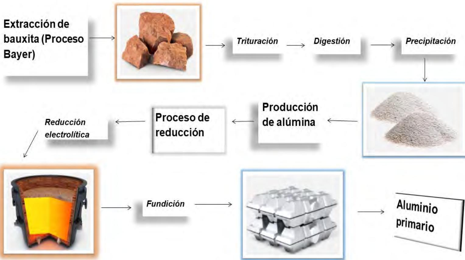
Figura 4. Diagrama de producción de aluminio primario
