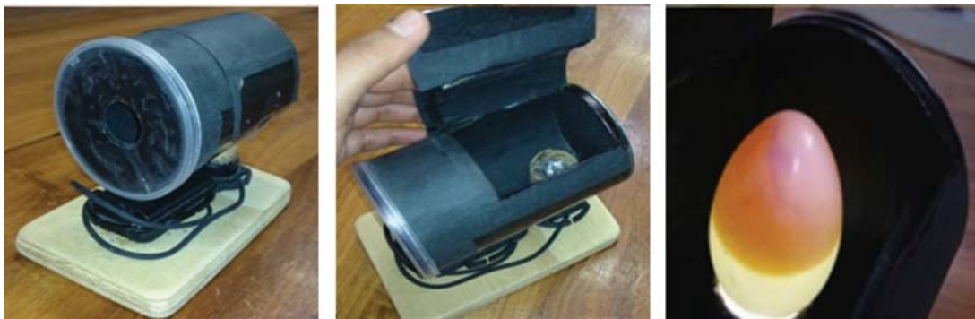
Figura 37: Ovoscopio casero para realizar la observación a trasluz. Figura 38: Interior del ovoscopio.
