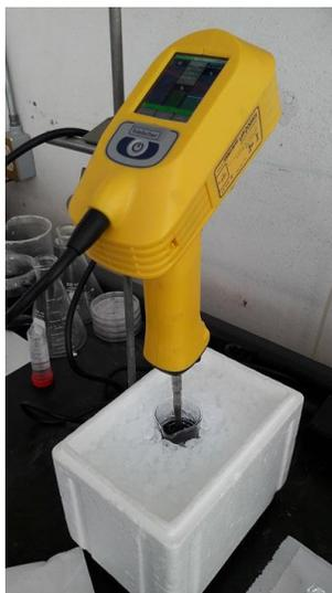
*Figura 7. Sistema para la exfoliación de óxido de grafito empleando una pistola de sonicado.*
