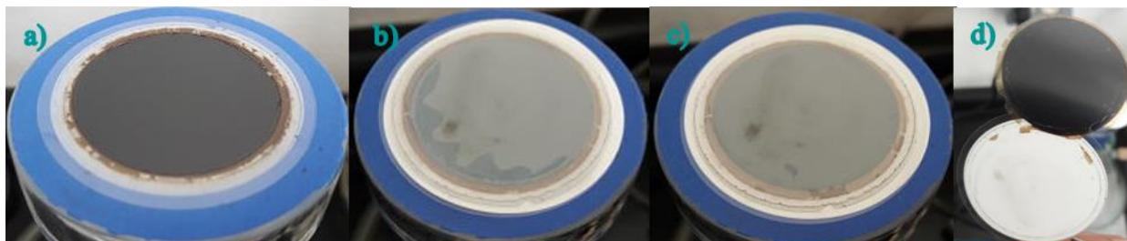
*Figura 14. Remoción del pGO sobre la membrana. a) pGO/membrana anódica al finalizar la filtración (vista superior); pGO/membrana anódica (vista inferior), b) antes del proceso de filtrado a contraflujo, en donde la parte oscura en la zona inferior izquierda muestra regiones adheridas electrostáticamente, y c) después del proceso de filtración a contraflujo, sin zonas de adherencia; d) pGO removido de la membrana anódica.*
