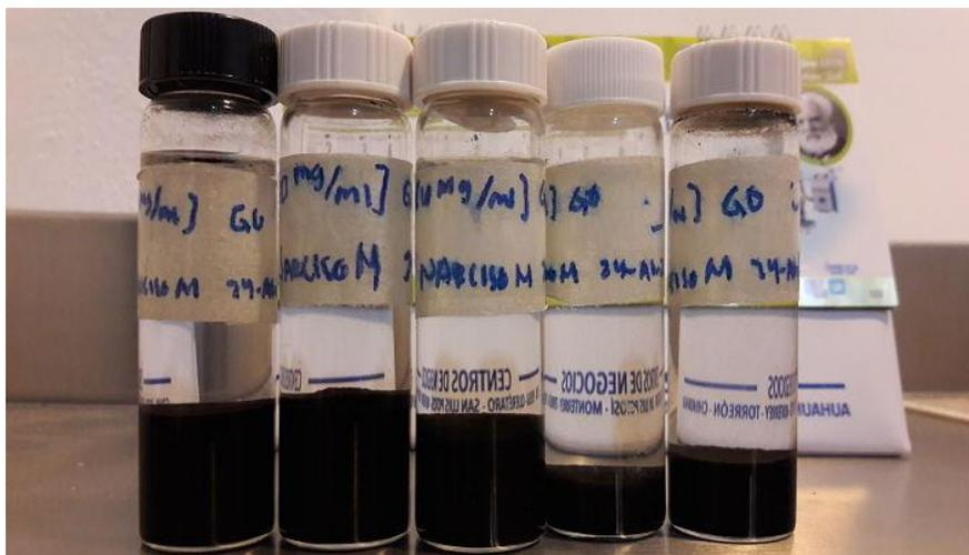
*Figura 9. Dispersiones acuosas de GO después de tres días de reposo. Los cinco viales fueron fijados a una posición determinada y sonicado por tres horas al mismo tiempo como se muestra en la Figura 9b.*
