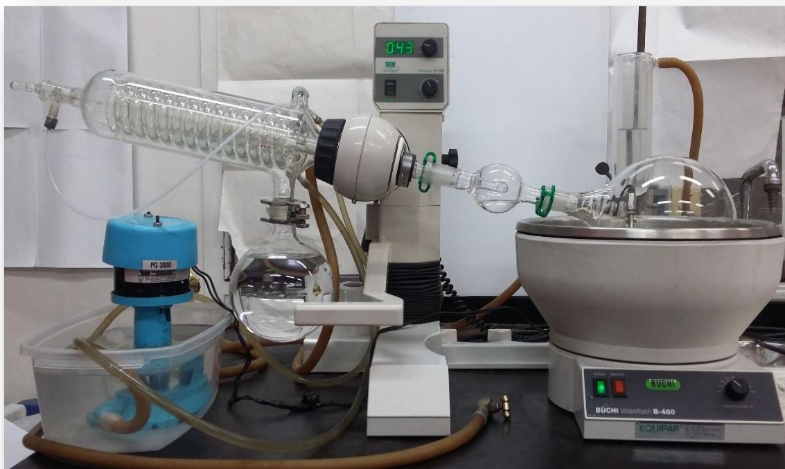
Figura 16. Evaporación del disolvente a presión reducida mediante rotaevaporador Büchi modelo R-124.
