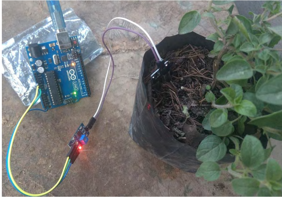
Ilustración 4.4 prueba realizada a sensor de humedad
