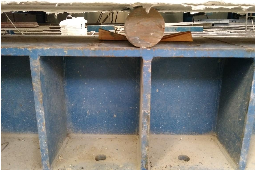
Figura 15. Rodillo de acero bajo el cabezal inferior (Créditos: Héctor Guerrero)
