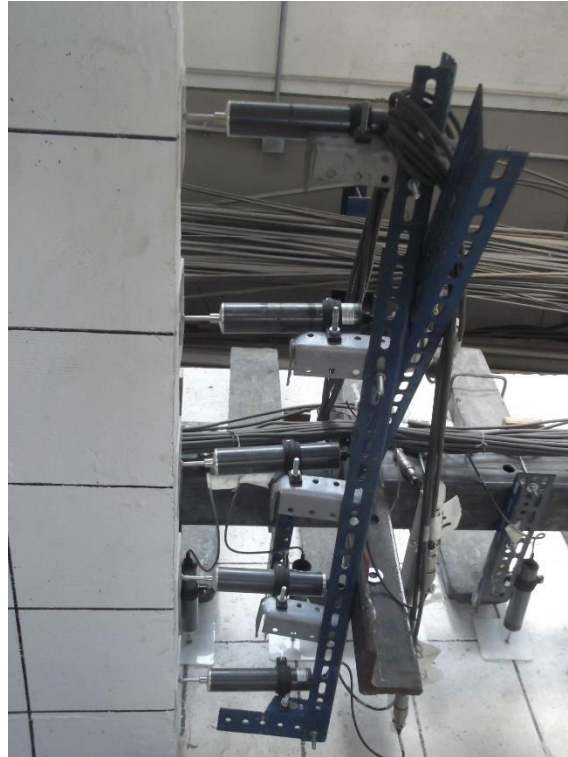
Figura 19. Instalación de LVDT en el muro superior
