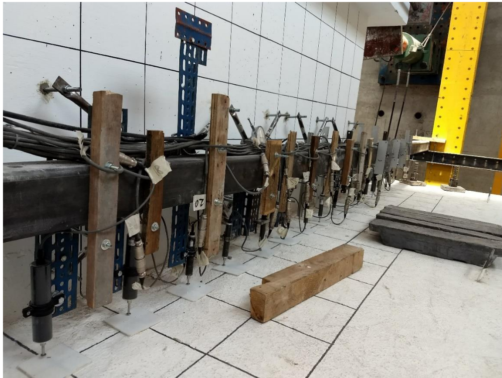
Figura 18. Instalación de LVDT a lo largo de la losa (Créditos: Luis Morales)
