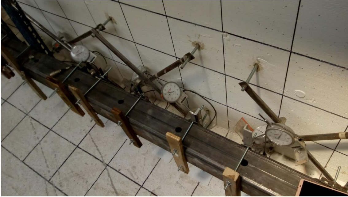
Figura 17. Instalación de micrómetros en el muro superior (Créditos: Juan Gómez)
