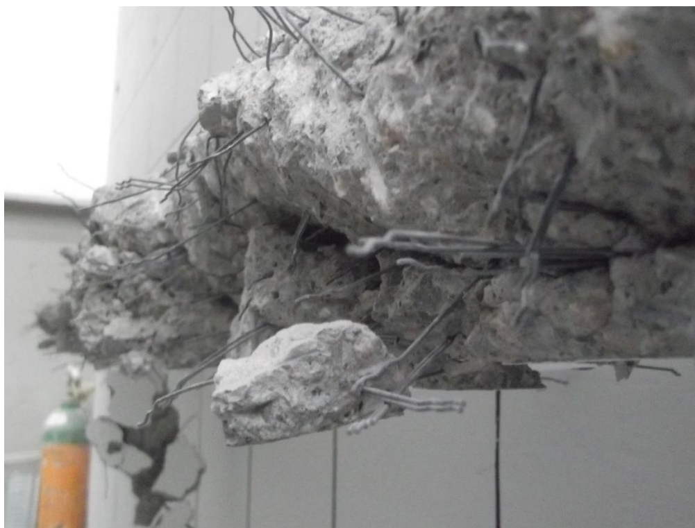
Figura 48. Distribución aleatoria de fibras en el concreto
