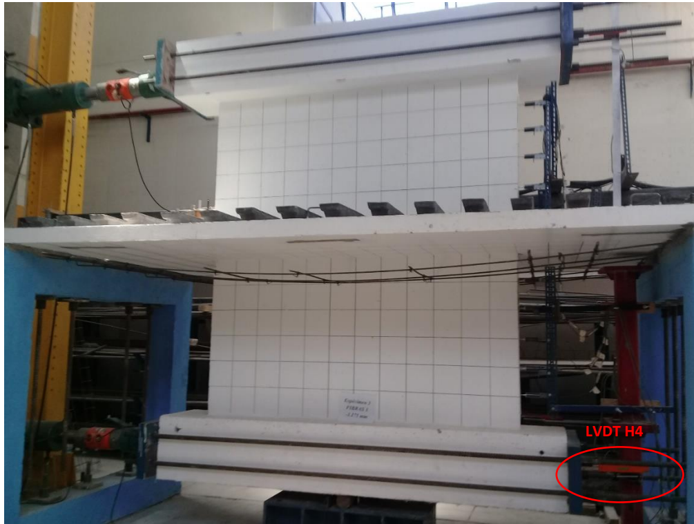
Figura 24. Colocación de barras de seguridad (Créditos: Eduardo Martínez)
