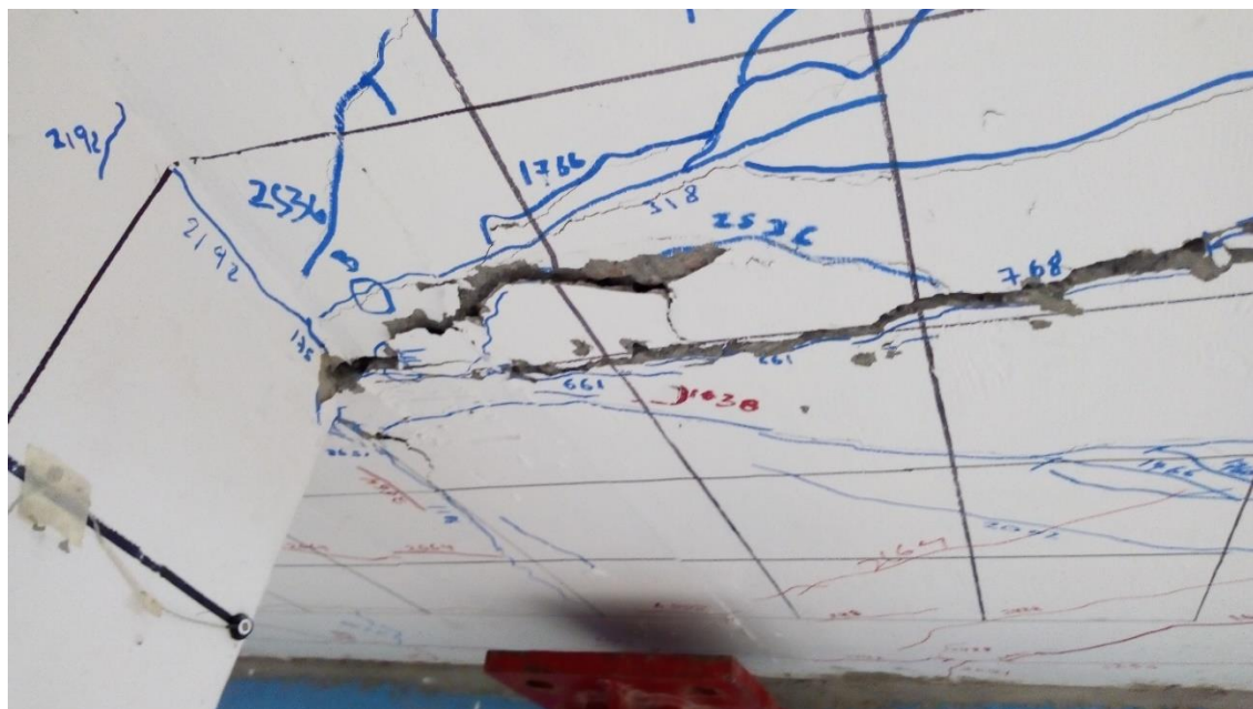
Figura 44. Efectos de la fibra en el concreto de la superficie
