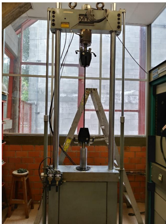
Figura 25. Ensayo de barras de presfuerzo (Créditos: Héctor Guerrero)
