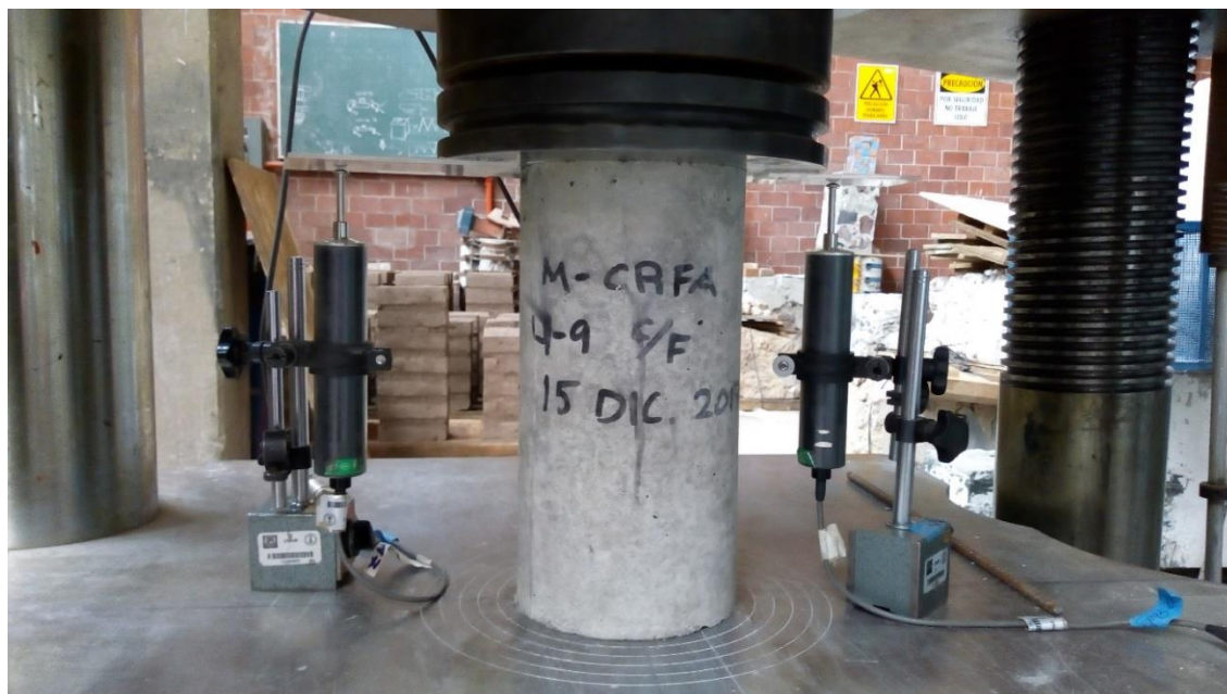
Figura 27. Ensayo de cilindros de concreto
