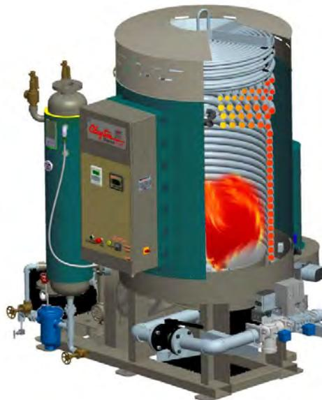
*Figura 2.1 GV de Circulación Controlada, Tipo LaMont con: Suavizador, Trampa de vapor, Tablero, Serpentín, Flama. Fuente: (Clayton de México S.A. de C.V., 2018)*
