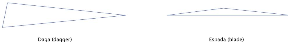
**Figura 5.3:** Un triángulo con mala forma geométrica.
