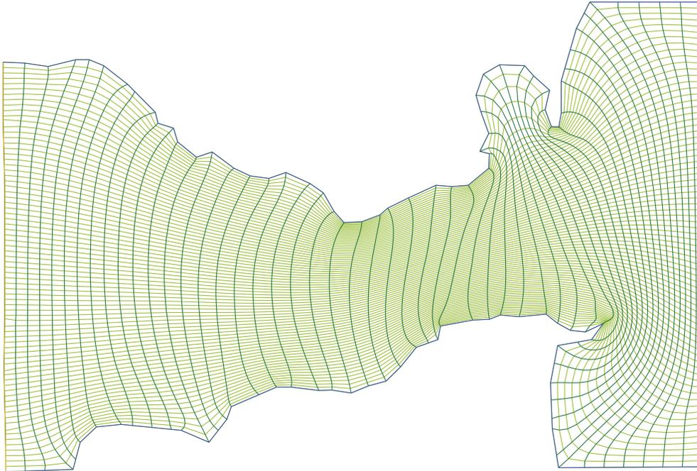
**Figura 6.18:** Estrecho de Gibraltar, malla de  $77 \times 55$  obtenida optimizando  $(1-\sigma)H_\omega(G) + \sigma F_{AO}(G)$  para  $\sigma = 0.5$ .
