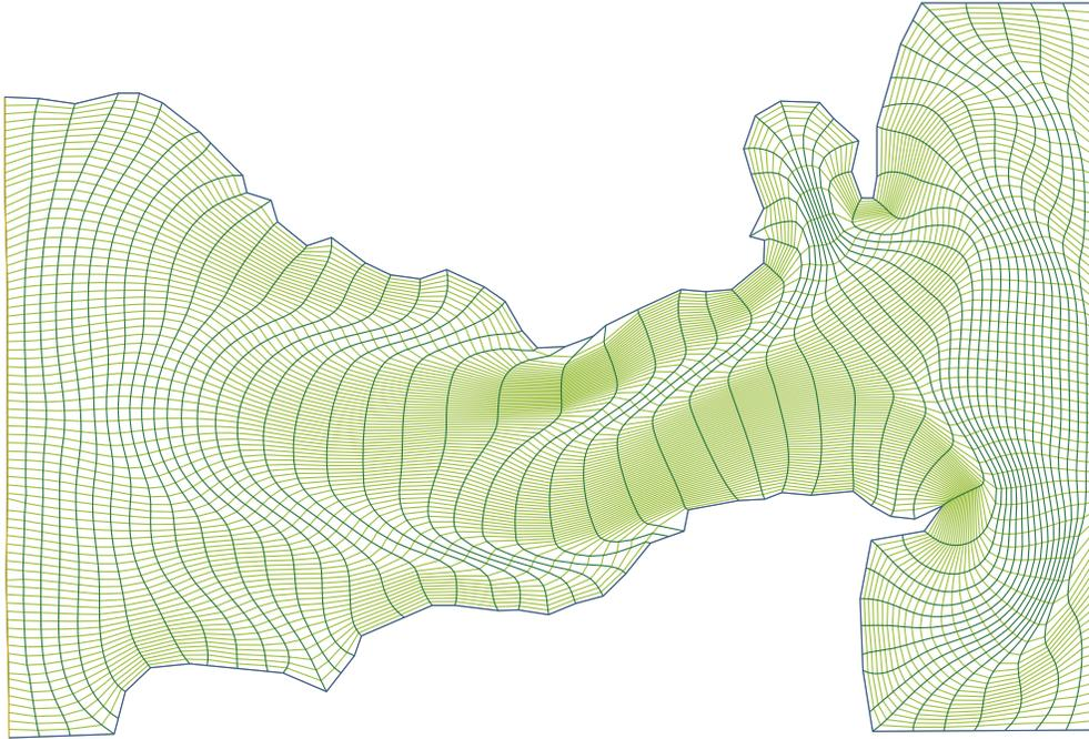
**Figura 6.12:** Estrecho de Gibraltar, malla de  $77 \times 55$  obtenida optimizando  $(1-\sigma)S_{\omega,\epsilon}(G) + \sigma F_{Ra}(G)$  para  $\sigma = 0.5$ .
