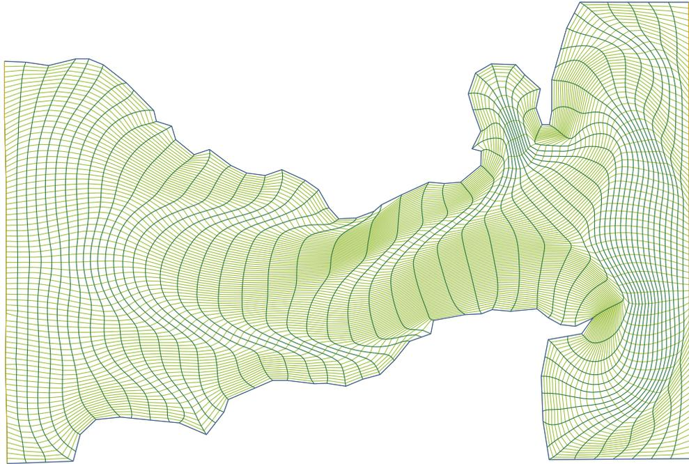
**Figura 6.14:** Estrecho de Gibraltar, malla de  $77 \times 55$  obtenida optimizando  $(1 - \sigma)S_{\omega,\epsilon}(G) + \sigma F_{AO}(G)$  para  $\sigma = 0.5$ .
