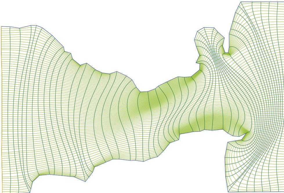
**Figura 6.23:** Estrecho de Gibraltar, malla de  $77 \times 55$  obtenida optimizando  $(1-\sigma)S_{\omega,\epsilon}(G) + \sigma F_{Rd}(G)$  para  $\sigma = 0.99$  y  $\beta = 1.0$ .
