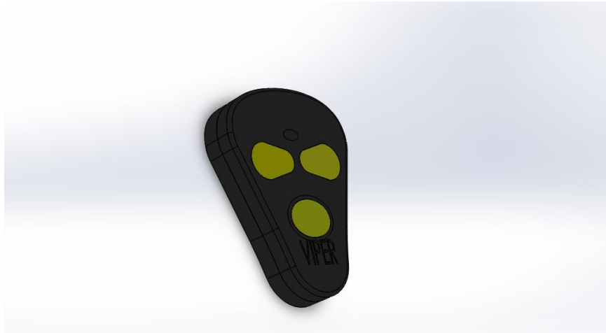
Figura 48: Carcasa del RKE diseñada en SolidWorks
