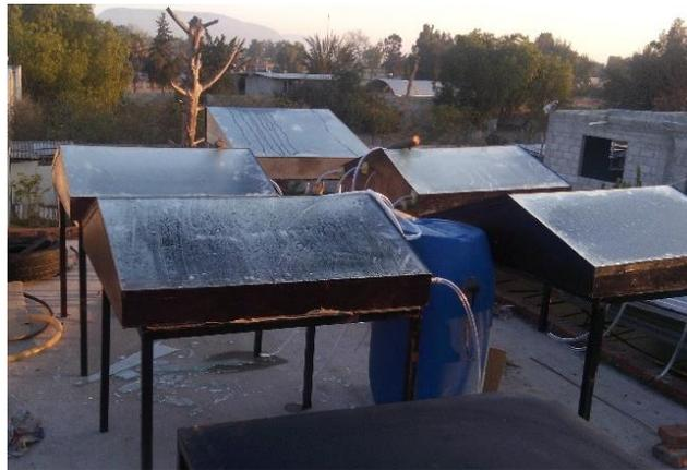
Figura 4-8 Destiladores solares reales de invernadero utilizados para las mediciones
