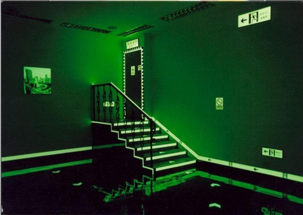
**Figura 1.4: Fotoluminiscencia aplicada en señalamientos**
