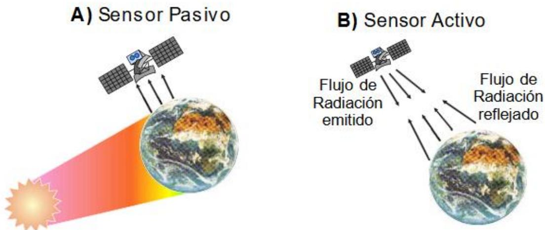
Figura 2.6 Diferenciación gráfica entre sensores pasivos y sensores activos. (Pérez, 2007)
