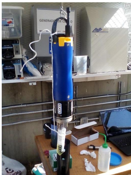
Figura 17 Calibración de la sonda EXO 3
