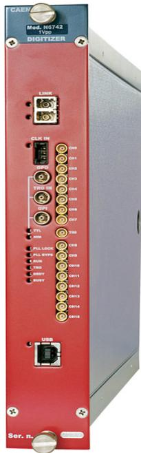
**Fig 3.22. FAST ADC CAEN Modulo Digitalizador CAEN N6742.**
