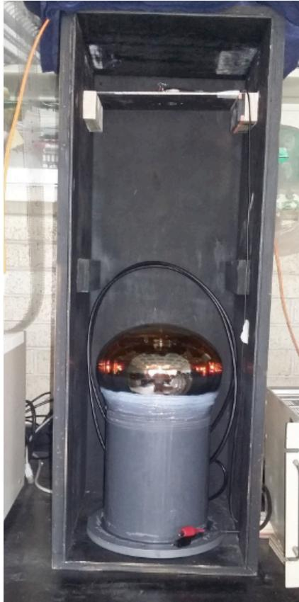
**Fig. 4.25. Tubo PMT en el interior de la caja de madera**
