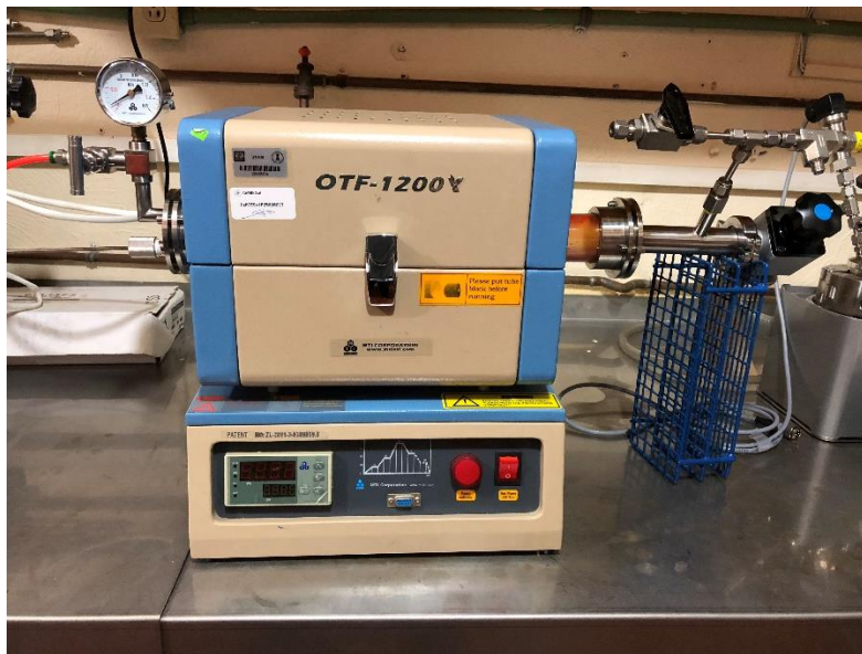
Figura 3.3. Horno tubular utilizado para los tratamientos térmicos
