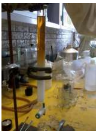
Figura 25. Columna cromatográfica de Sephadex LH20
