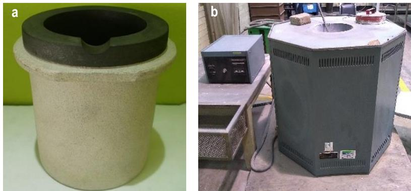
Figura 3.2. a) Crisol de grafito, b) Horno de piso.
