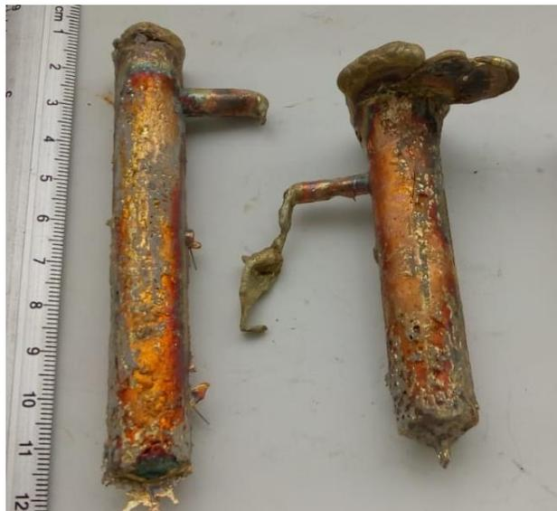
**Figura 3.3. Probetas de latón 70/30 por colada**
