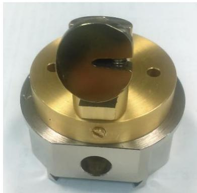
Figura 3.6. Pieza agrietada, montada para el análisis por EBSD.
