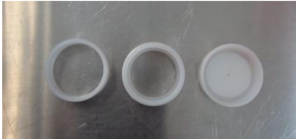
Figura III.1. Porta muestra para materiales en estado sólido en forma de polvo (de izquierda a derecha: anillo, cilindro rígido, tapa de contención).
