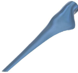
Figura 31. Diseño en CAD de Aspa final de la TEF, vista 2.
