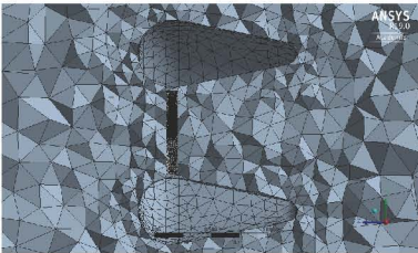
Figura 76. Discretización de volumen de control y volumen rotatorio (Plano YZ).
