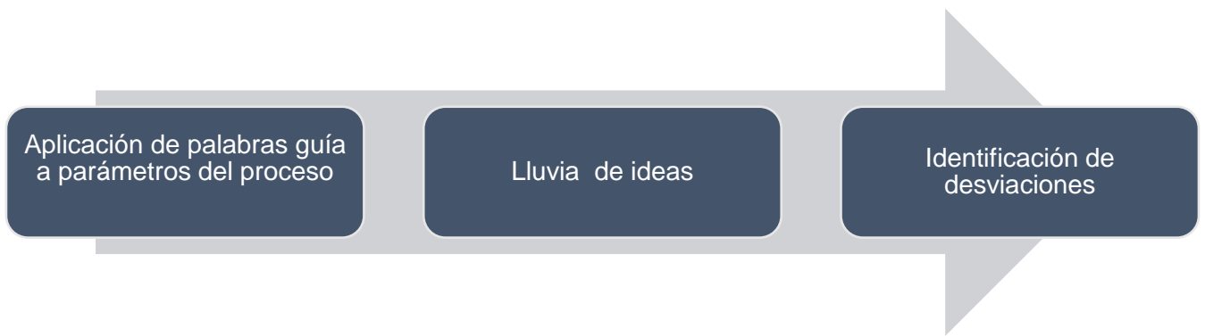
Figura 21. Proceso para realizar un HAZOP. Creación propia a partir de la Información tomada de la fuente: Rodriguez, J. (2012). Quality Risk Management in the FDA-Regulated Industry. ASQ Quality Press Milwaukee, Wisconsin.
