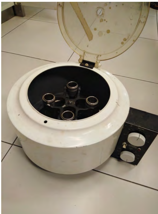
Figura 22: Imagen de la centrifuga de cuatro celdas operada a 400 rpm utilizada en el proyecto.
