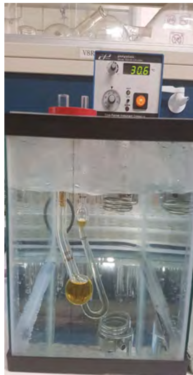
Figura 24: Imagen del sistema para determinación de viscosidad, viscosímetro gravitacional Cannon-Fenske 300 con control de temperatura integrado.
