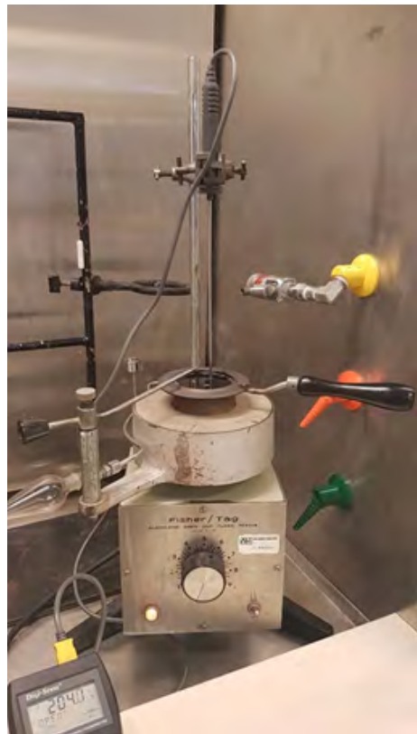
Figura 26: Imagen del equipo Cleveland Open Cup utilizado en la determinación de punto flash.
