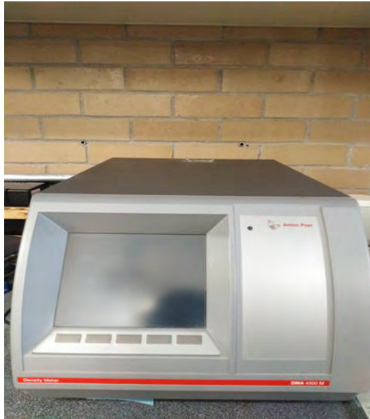
Figura 23: Imagen del densímetro de tubo oscilante ANTON PAAR utilizado en el proyecto.
