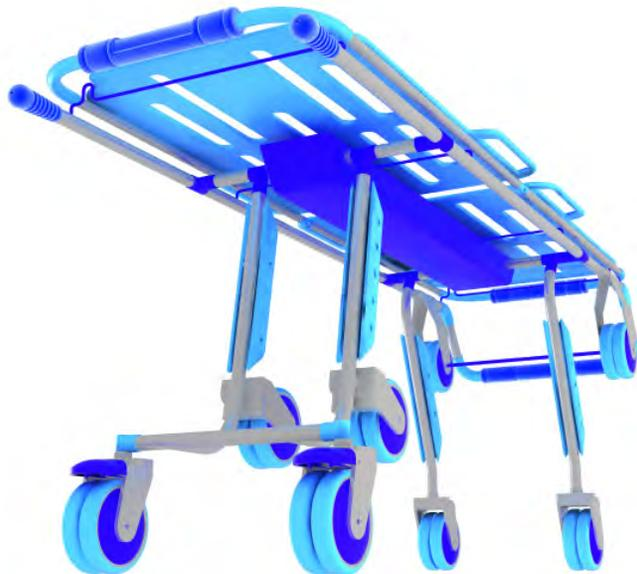
Una de las principales ventajas en el rediseño del módulo de transporte superior fue el delineamiento e integración de una colchoneta segmentada simétricamente cuya configuración formal y funcional le permite reconocer todos y cada uno de los movimientos efectuados por la estructura tubular que la soporta durante las labores cotidianas de trabajo.
