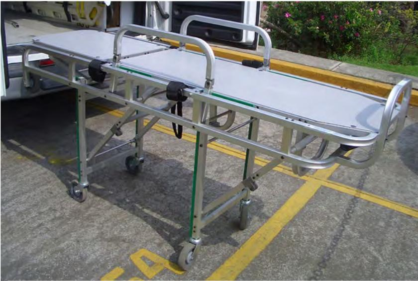
Una particularidad interesante de este objeto de diseño fue el uso de una superficie de policloruro de vinilo (PVC) espumado (de 6mm) empleado como base de reposo. Lamentablemente este pequeño error puede magnificarse considerablemente durante una reanimación cardiopulmonar, debido a la falta de rigidez estructural e inestabilidad de esta zona, por lo cual este hecho no hace apropiado al producto para labores de atención prehospitalaria crucial.
