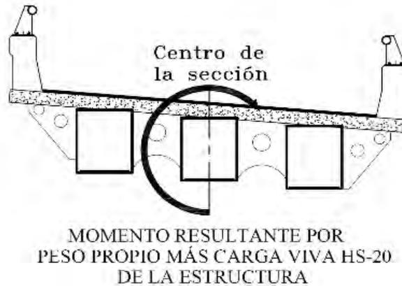
Figura 5.15. Sentido del momento resultante causado por peso propio y por el vehículo HS-20.
