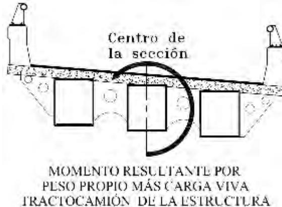
Figura 6.8. Sentido del momento resultante causado por peso propio y por el vehículo TRACTOCAMIÓN.
