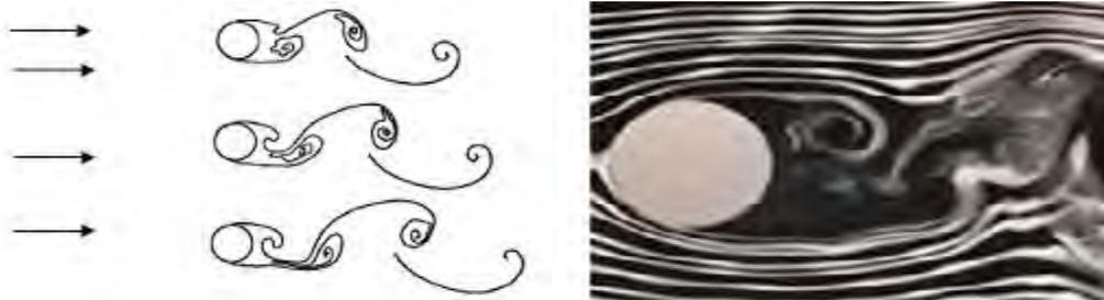
Figura 1.38 Vibraciones inducidas por vórtices<sup>69</sup>
