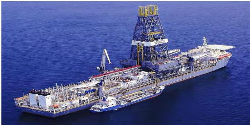
Figura 1.15 Barco de perforación de actividad Dual<sup>21</sup>
