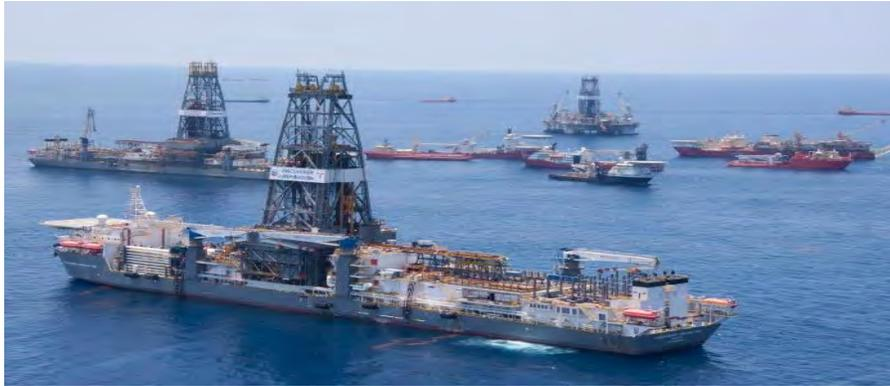
Figura 1.13 Barco Perforador<sup>18</sup>
