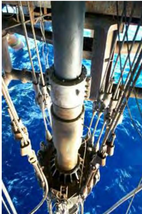
Figura 1.21 Junta Telescópica<sup>31</sup>
