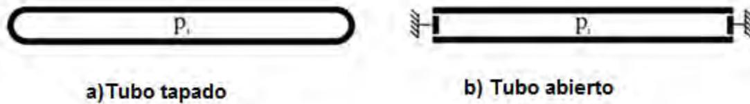
Figura 2.13 Tubo tapado y abierto bajo presión<sup>86</sup>
