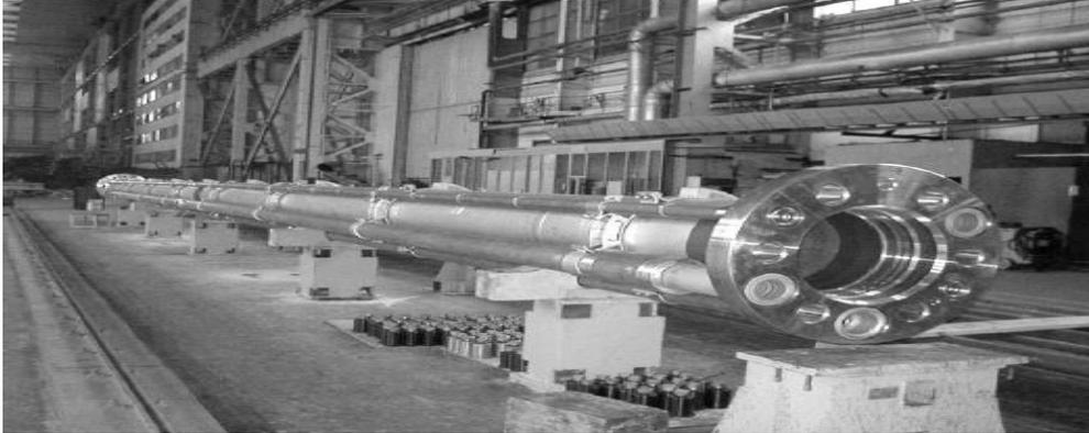
Figura 1.30 Riser de perforación de aluminio<sup>47</sup>
