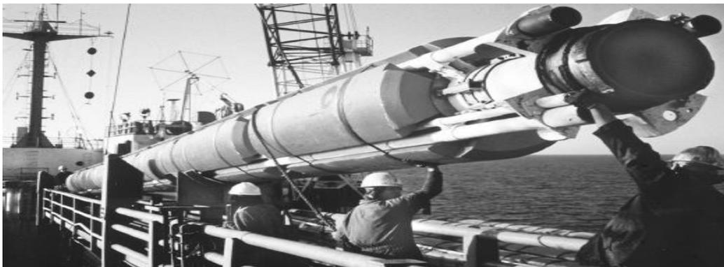
Figura 1.29 Conector de bloque de cierre<sup>46</sup>
