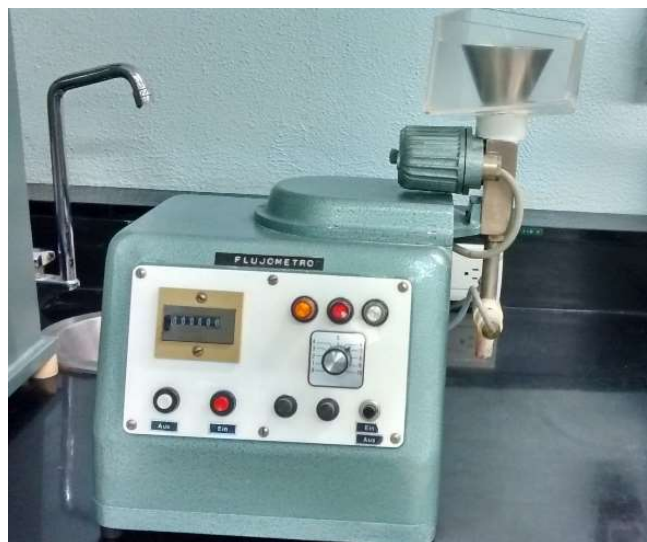
Figura 9. Equipo utilizado para la determinación de la velocidad de flujo.
