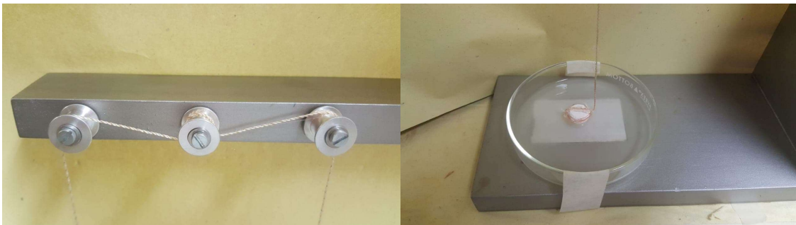
Figura 33. Juego de poleas y base del sistema empleado para realizar la prueba de fuerza de bioadhesión.
