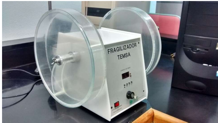
Figura 14. Imagen del equipo utilizado para la determinación de friabilidad.
