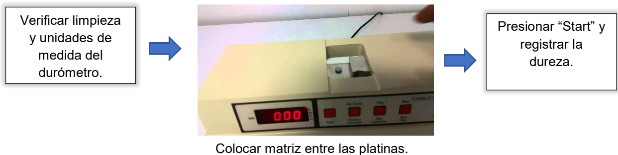
Figura 29. Metodología empleada para realizar la prueba de dureza.
