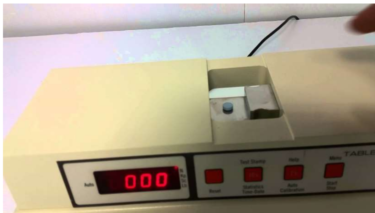
Figura 13. Equipo utilizado para la medición de resistencia a la ruptura.
