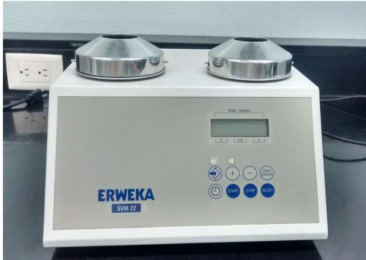
Figura 11. Equipo utilizado para la determinación de la densidad aparente y compactada.
