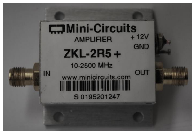
Figura 5.12 Amplificador de RF con terminales SMA coaxial.
