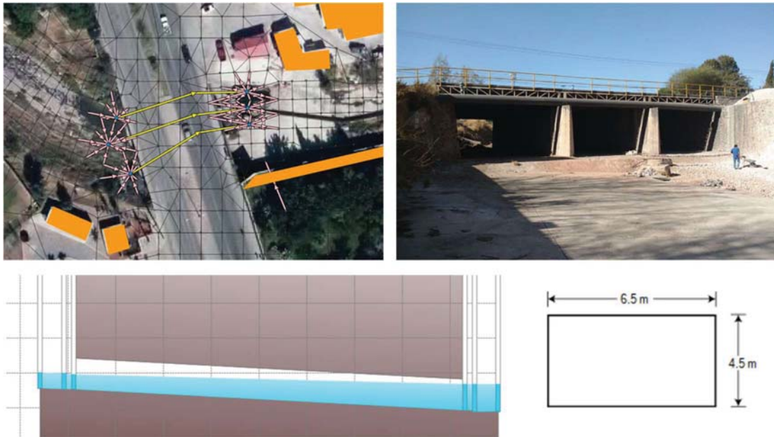
Figura 77.- Ejemplo de estructura de cruce en PCSWMM®, arroyo El Mimbresur y avenida Heroico Colegio Militar. Fuente: elaboración propia.
