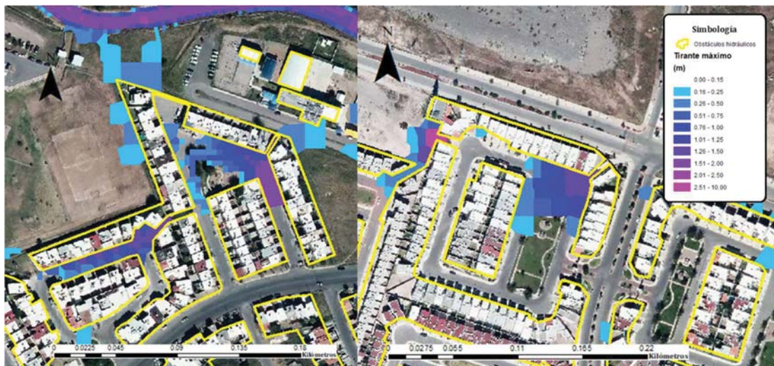
Figura 90.- Remanso en fraccionamientos privados por incapacidad hidráulica en pasillos pluviales. Fuente: elaboración propia.
