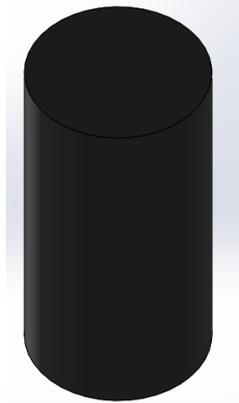
**Figura 23.** Representación esquemática 3D de la probeta de hierro vermicular utilizada en el experimento (Dimensiones: altura= 12cm y diámetro = 5cm).
