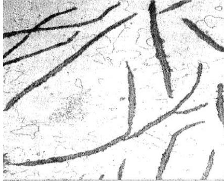
**Figura 1.** Fundición gris ferrítica. Láminas de grafito sobre un fondo blanco de cristales de ferrita a 416X.
