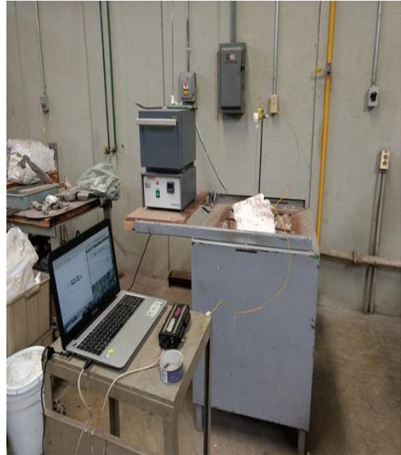
**Figura 24.** Equipo utilizado para el tratamiento de Austemperizado.
