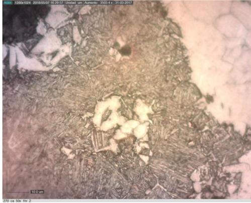
**Figura 48.** Metalografía resultante del proceso de Austempering a 270°C y hora, a 848X.
