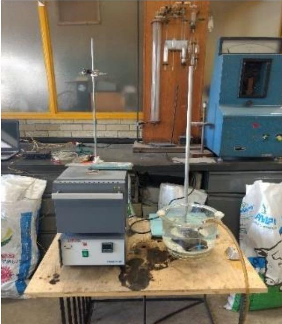
**Figura 23.** Equipo utilizado para obtener temperatura Ms
