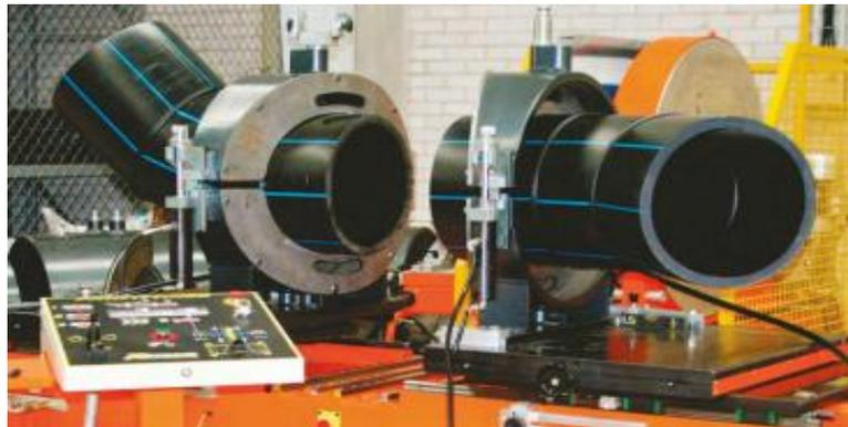
**Ilustración 6:** Sistema de unión para tubería de Polietileno.
