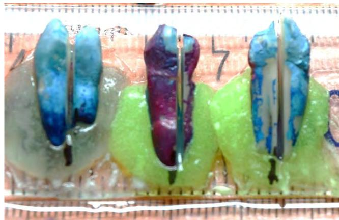
Figura 3. Corte mesiodistal de las muestras de la prueba de microfiltración. Fuente directa
