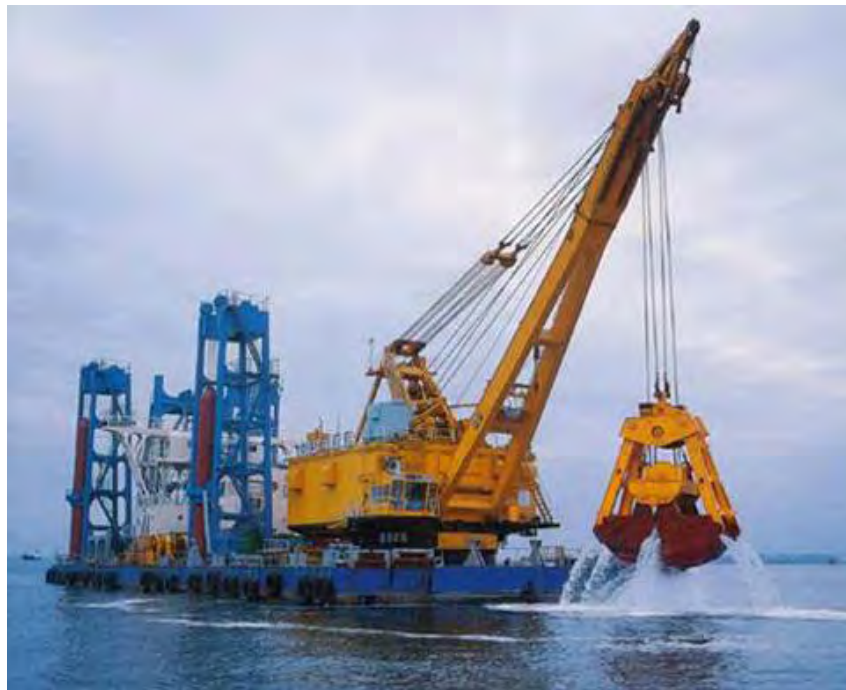
Figura 4. 8. Draga de cuchara de almejas.
