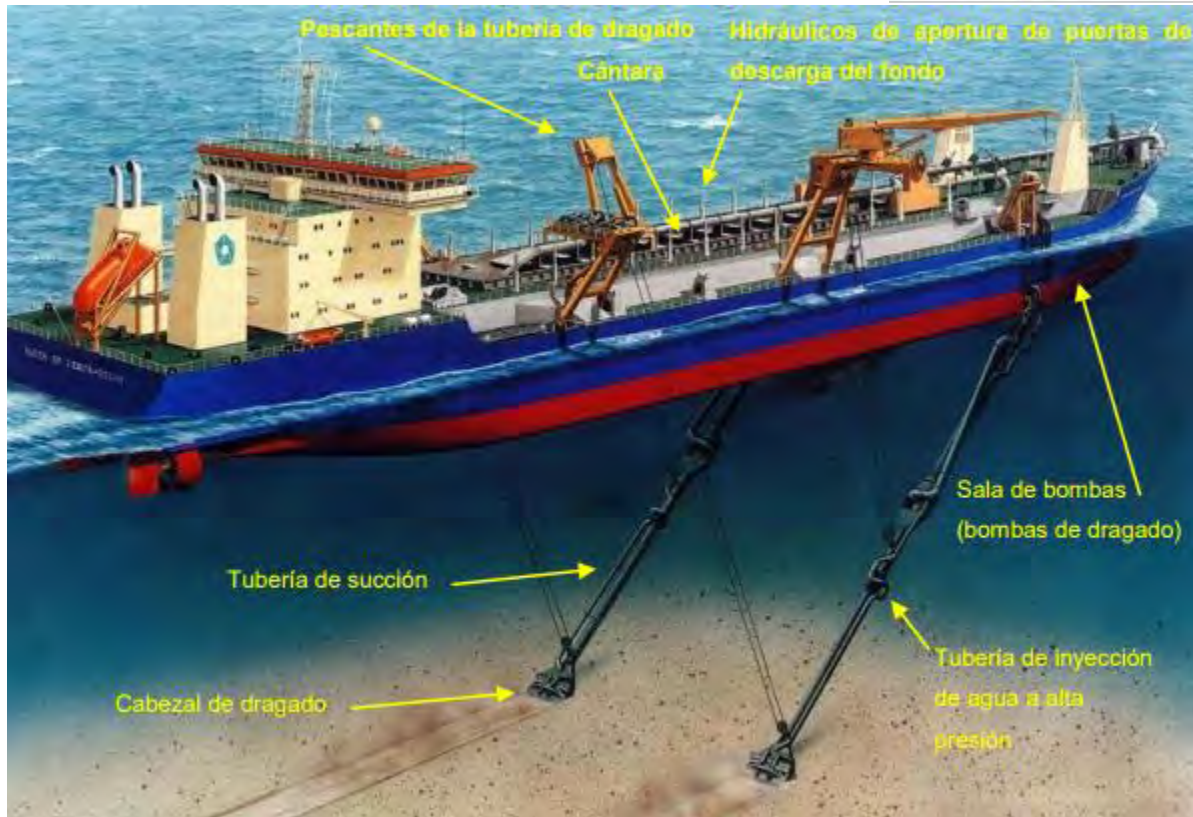
Figura 4. 5. Croquis, draga de succión por arrastre.
