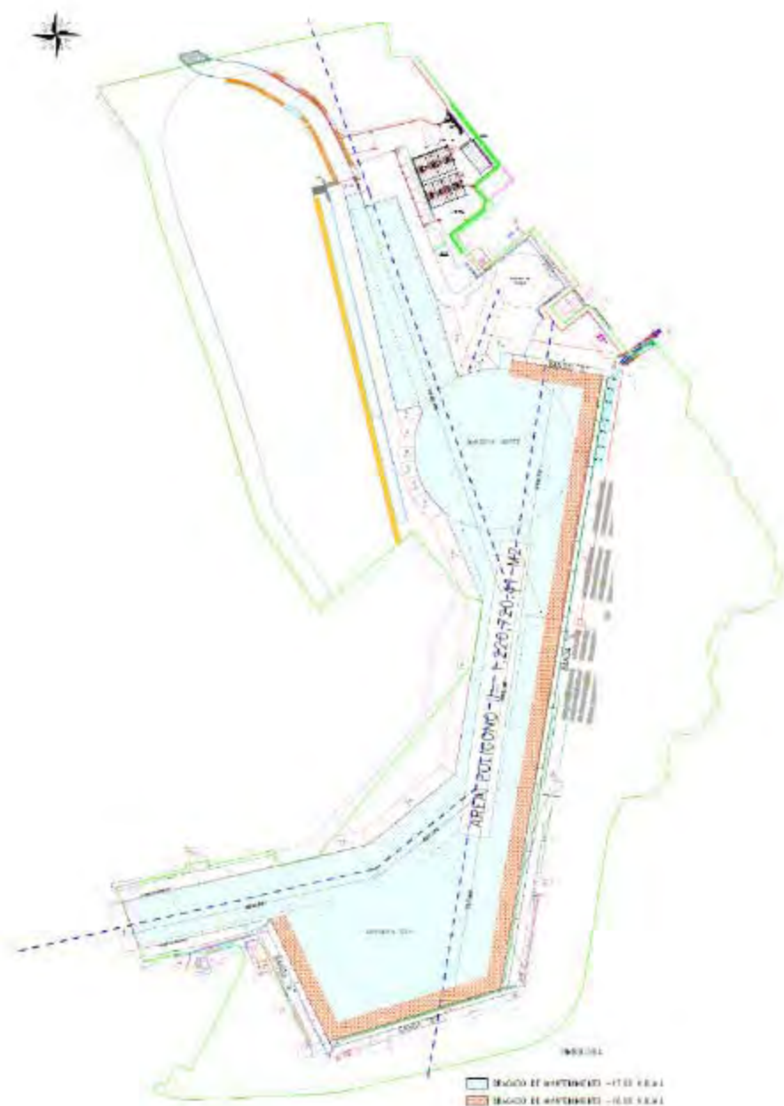
Figura 2. 3. Croquis de dragado de mantenimiento en el Puerto Interior de San Pedrito, Manzanillo, Col. Fuente: Estudio técnico. Cartera Pública de Inversión, SHCP, 2017.
