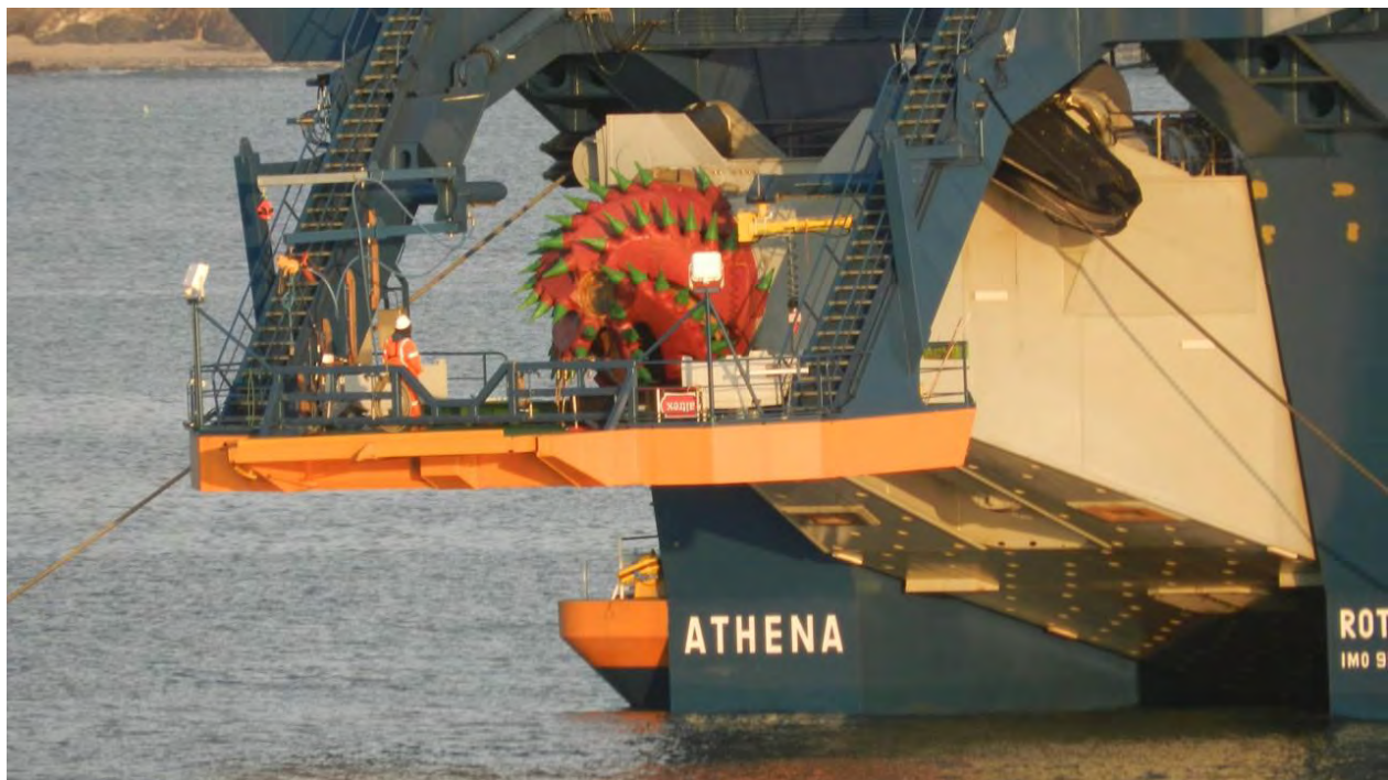
Figura 4. 13. Cortador de la draga. Fuente: DRAVOSA. Dragas de cortador.
