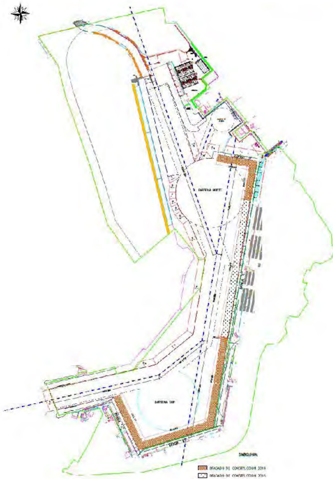
Figura 2. 2. Croquis de dragado de construcción en el Puerto Interior de San Pedro, Manzanillo, Col. Fuente: Estudio técnico. Cartera Pública de Inversión, SHCP, 2017.
