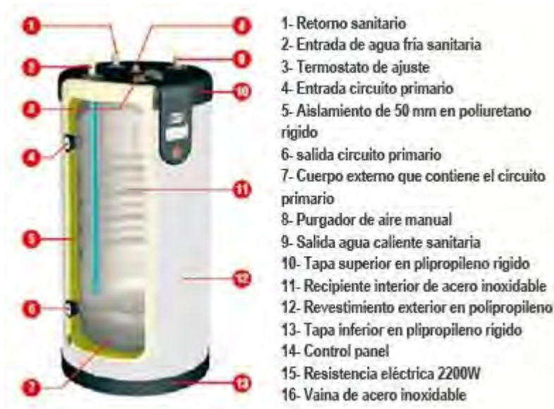
Ilustración 47 Interacumulador o tanque térmico sin sistema de intercambio
