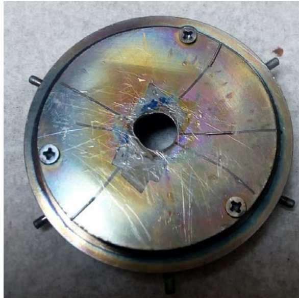
Figura 16. Portasustrato maquinado para el presente trabajo.
