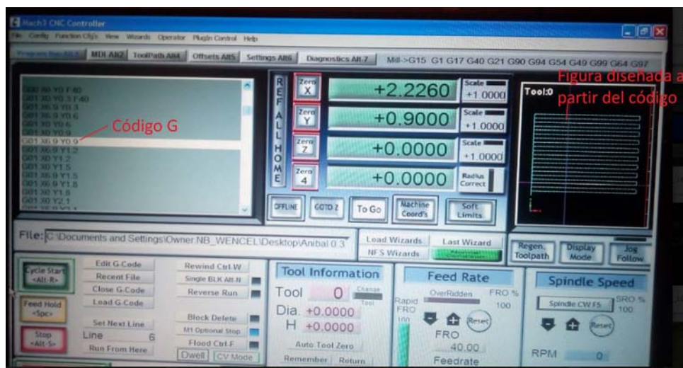
Figura 11. Programa utilizado para el movimiento de los motores de paso, se muestra el código G que se utilizó para mover el carrusel de blancos.
