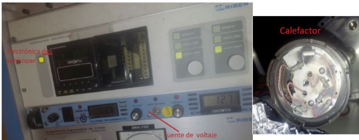
Figura 13. Fuente de voltaje utilizada para calentar el calefactor fabricado y electrónica del termopar.
