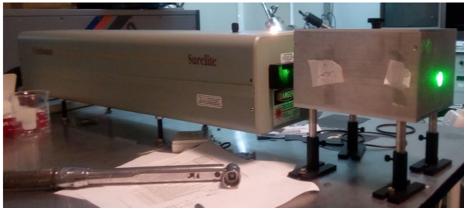
Figura 15. Láser de Nd:YAG utilizado para el depósito de películas delgadas.
