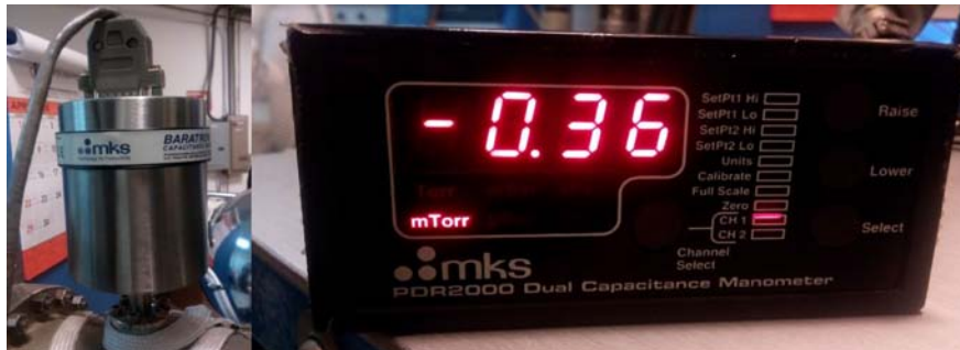
Figura 14. Medidor de presión de N_2 utilizado durante el depósito.
