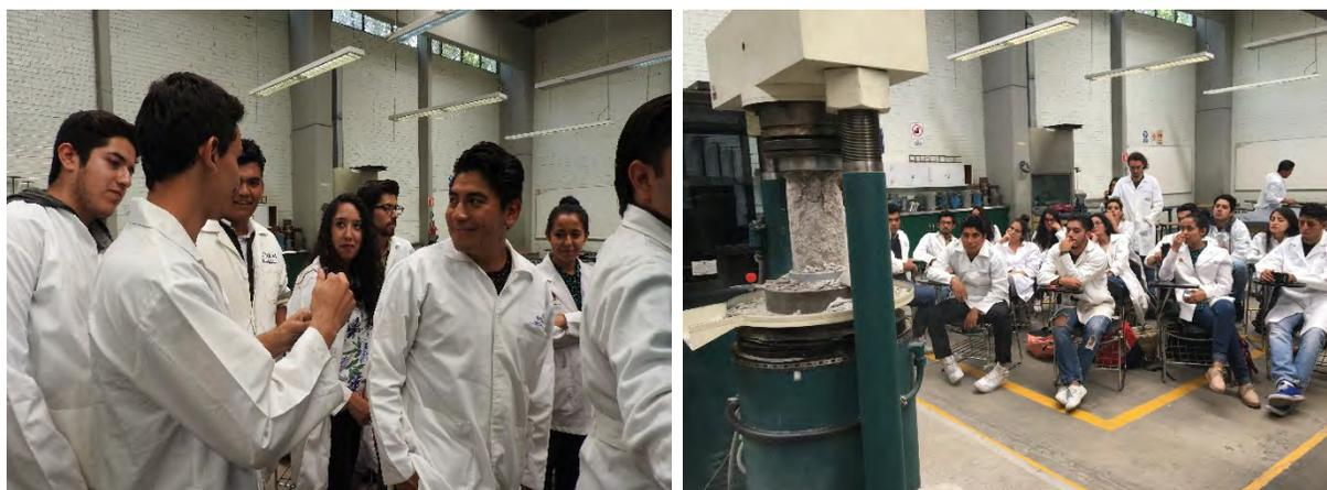
*Figura 23. Pruebas de compresión en cilindros de concreto*
