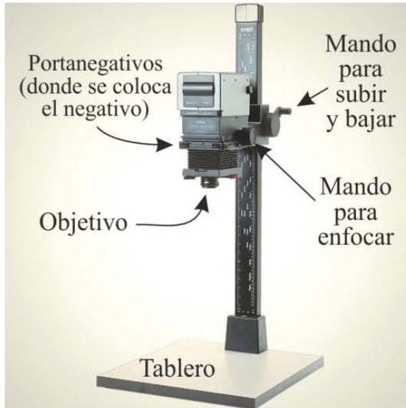
Imagen 70 Diagrama que ejemplifica las partes principales de la ampliadora fotográfica
