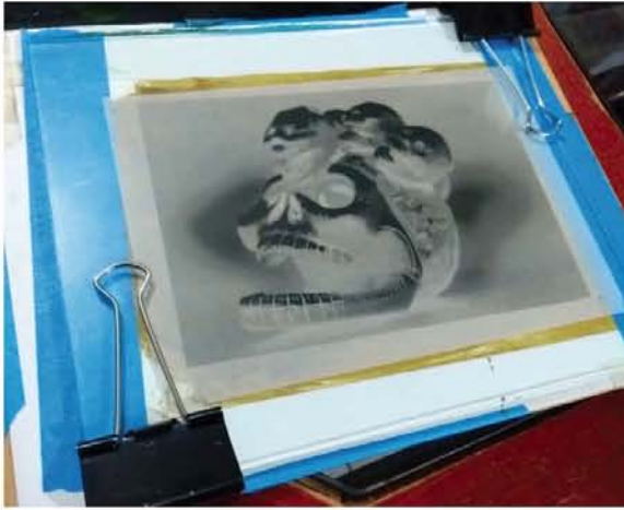
Imagen 121 Montaje de papel emulsionado y negativo en prensa de copiado
