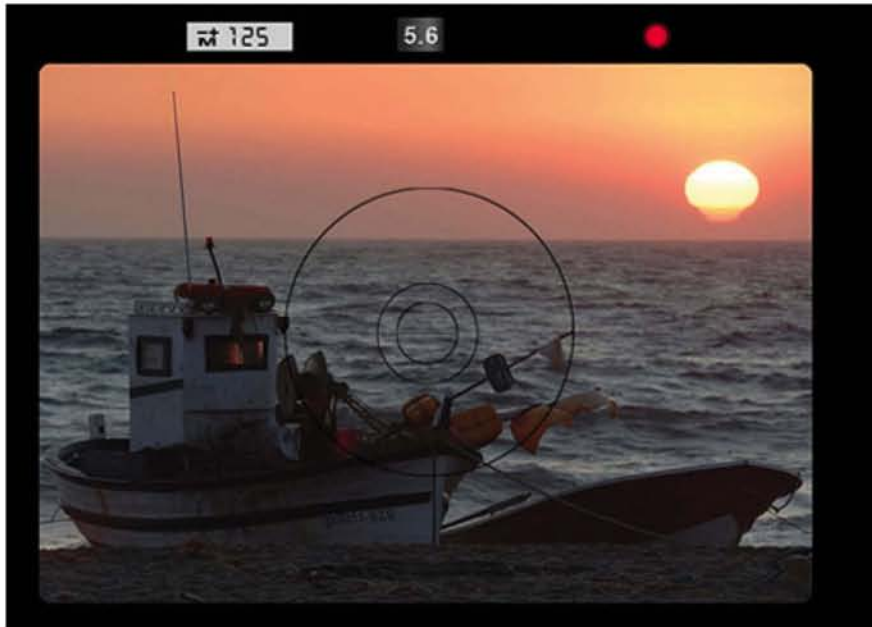
Imagen 13 Ejemplo de visor de una cámara Nikon F3: líneas negras delimitan lo que realmente aparecerá en la imagen, en el centro aparece la zona de enfoque, en la parte alta son visibles los datos sobre la toma
