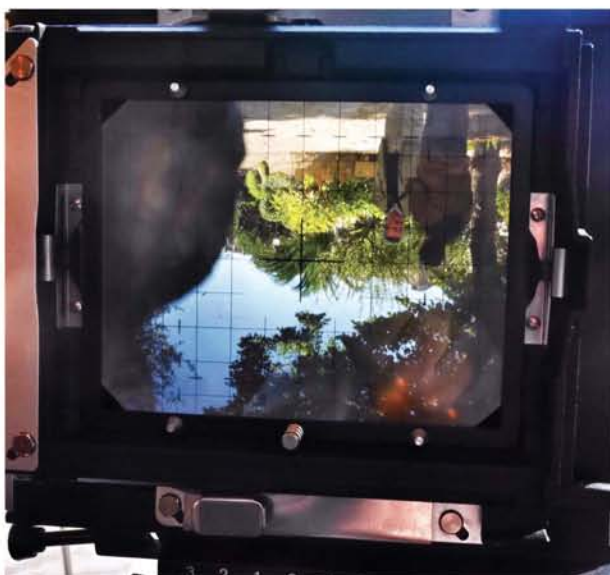
Imagen 10 Proyección en la parte trasera de una cámara de gran formato
