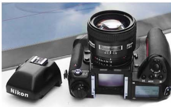
Imagen 47 Cámara Nikon F5 donde podemos ver la implementación de varios dispositivos electrónicos a la cámara mecánica
