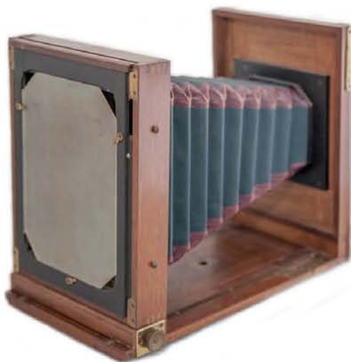
Imagen 40 El fuelle une el porta placa (lado izquierdo de la imagen) con el porta lente (lado derecho de la imagen)
